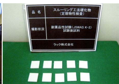
写真-3 浸せき後
